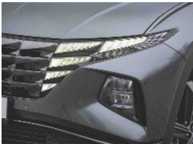
Efektivní světla denního svícení jsou přímo součástí masky chladiče. Hlavní a dálkové světlomety jsou pod nimi v nárazníku.
